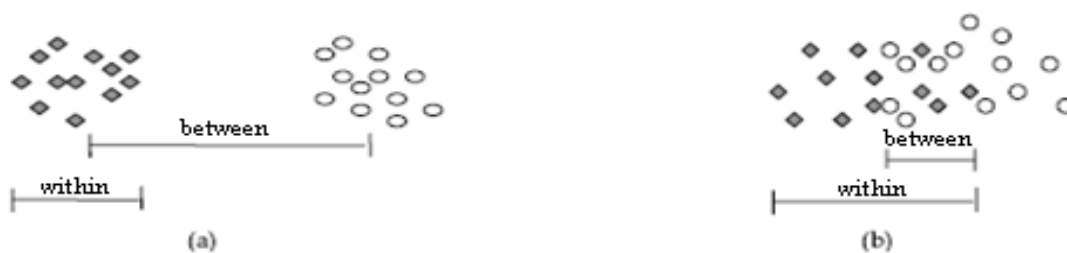
Figure 3.2 (a) la bonne séparation de classe (b) la mauvaise séparation de classe
